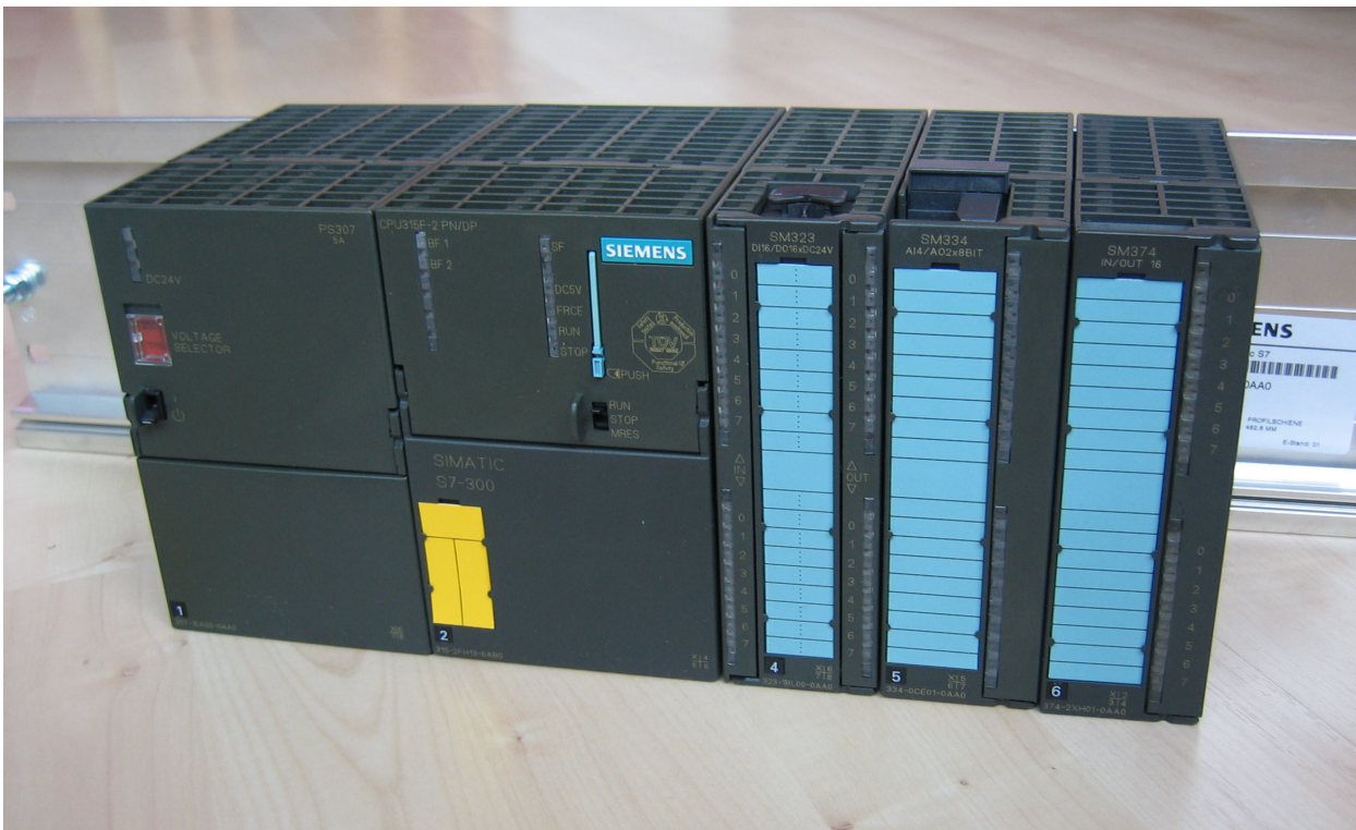
Figuur 3.1: De PLC S7-315 met I/O-modules.
